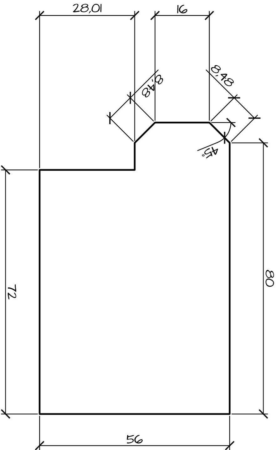
Tracer le contour de la figure ci-haut en utilisant les coordonnées absolues et les coordonnées polaires SEULEMENT
